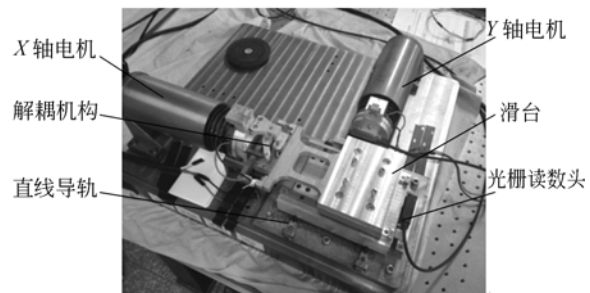
图 1 音圈电机 X-Y 运动平台结构图
